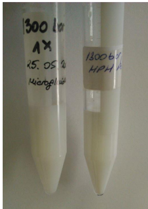
Slika 6: Nanoemuzije izradene pri tlaku od 1300 bara i jednim ciklusom - mikrofluidizacija (lijevo); visokotlačna homogenizacija (desno)
