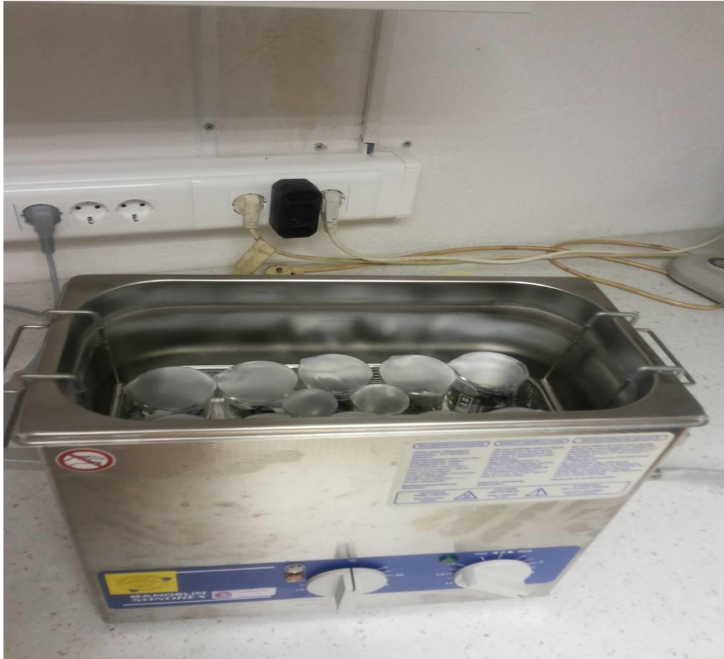
Slika 6. Ultrazvučna ekstrakcija biljnog materijala
