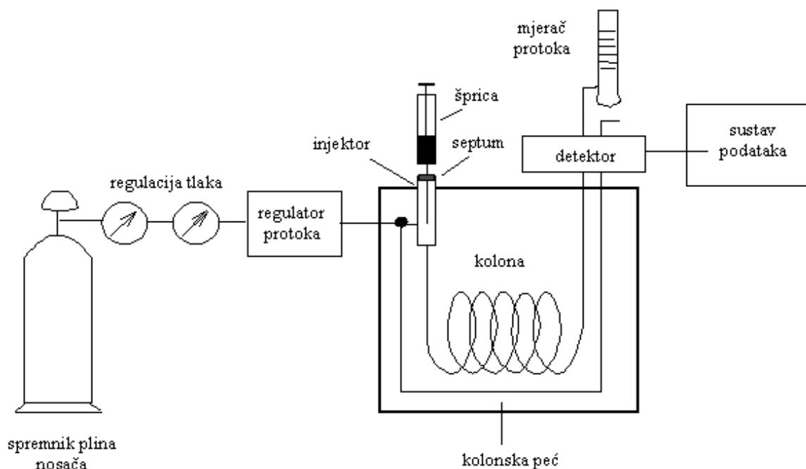
**Slika 1.** Shematski prikaz plinskog kromatografa (Luterotti, 2012).
