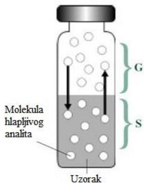
**Slika 2.** Shematski prikaz headspace injektiranja ([www.pharmainfo.net](http://www.pharmainfo.net)).
