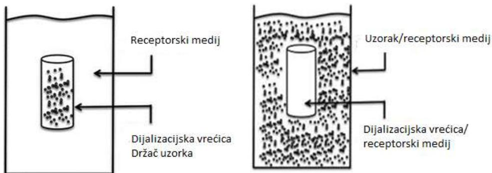
**Slika 9.** Shematski prikaz dijalize (lijevo) i obrnute dijalize (desno).
