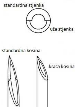
Slika 7. Prikaz standardne i uže stjenke igle te standardne i kraće kosine vrha igle
