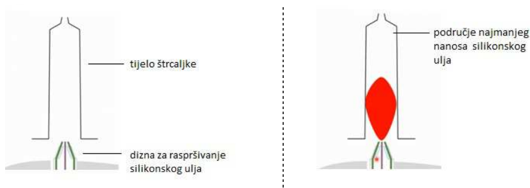
Slika 11. Prikaz statičkog raspršivanja silikonskog ulja po tijelu štrcaljke
