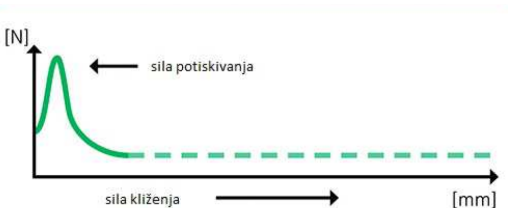
Slika 18. Grafički prikaz sile potiskivanja i sile kliženja
