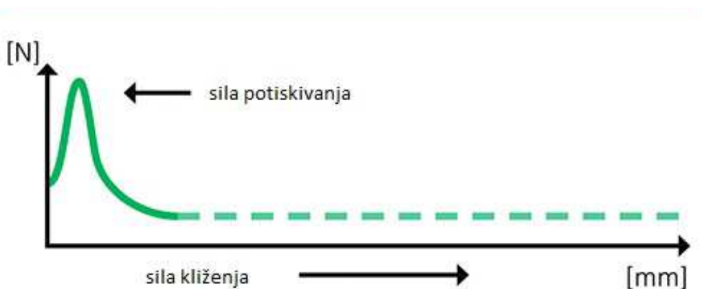
Slika 18. Grafički prikaz sile potiskivanja i sile kliženja
