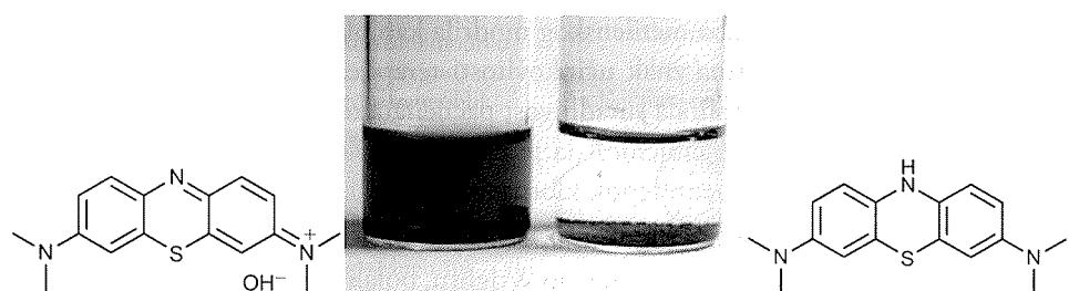
Slika 5. Oksidirana i reducirana forma metilenskog modrila.
