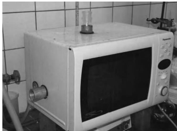
Slika 3. Kućanska mikrovalna pećnica modificirana za znanstvenu upotrebu. Na lijevoj strani su vidljivi otvor za IR termometar, na gornjoj je otvor za spajanje hladila, a ispod uređaja se nalazi magnetski mješač (Kappe i sur., 2012).
