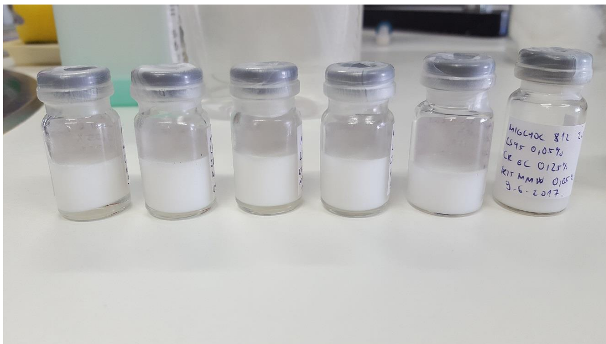
Slika 21. Nanoemulzije s 2,5% Miglyola 812, 0,05% lecitina S45, 0,25% Cremophora EL i kitozansom srednje molekulske mase (MMW), 30 dana nakon izrade.
