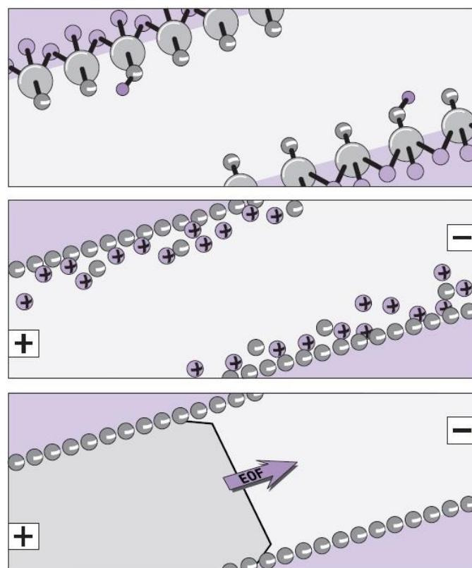
**Slika 3.** Uspostavljanje elektroosmotskog toka (Lauer i Rozing, 2009)
