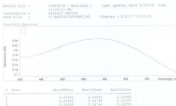
Slika 33. Spektar dobiven mjerenjem apsorbancije fenolnih kiselina u ekstraktu lovora sa Šipana.
