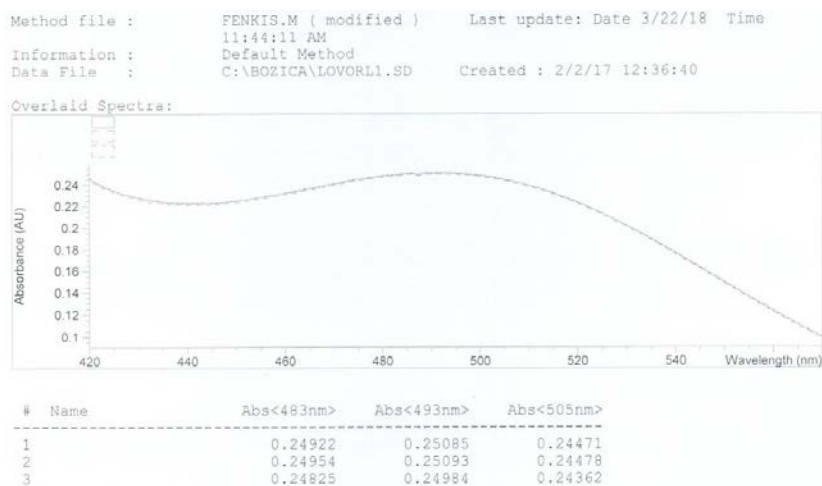
Slika 29. Spektar dobiven mjerenjem apsorbancije fenolnih kiselina u ekstraktu lovora s Lastova.
