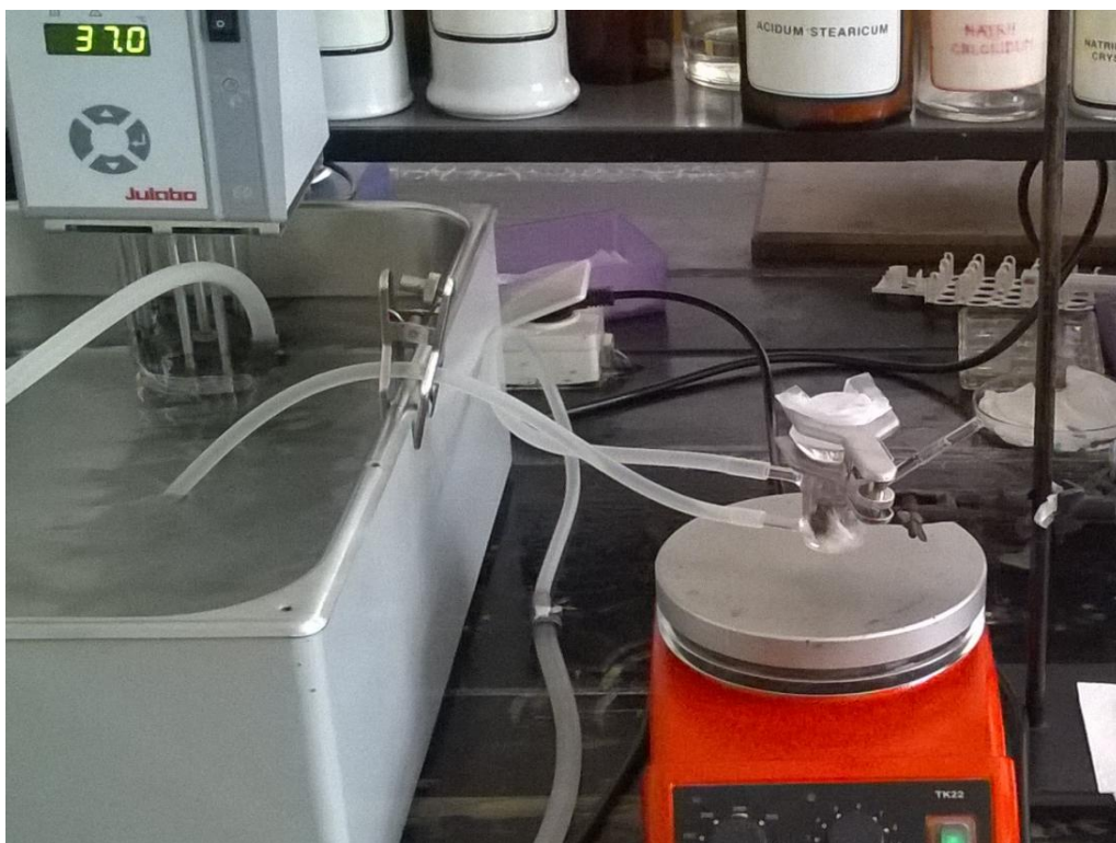
Slika 5. Ispitivanje oslobađanja deksametazona iz mikročestica na Franzovoj difuzijskoj ćeliji
